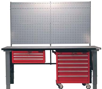
Набор панелей с опорными стойками и крепежом для установки на верстак. Панели перфорированы для использования различных крючков, держателей для инструмента и аксессуаров.
