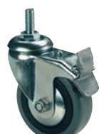
Комплект из 4 x 1¼" колес с ½"болтами. С двойными тормозами . Рассчитаны на нагрузку 80кг на 1 колесо или 250кг на 4 колеса.
