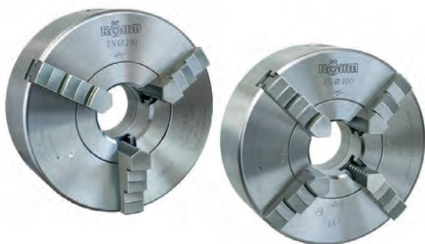
Зажимной патрон с торцевой спиралью - проверенное зажимное средство с высокой степенью универсальности - для успешного применения там, где требуются экстремально высокие зажимные усилия, высокие требования к допустимому радиальному биению а также к повторяемости высоких параметров точности в течение длительного времени. Для универсального использования на токарных станках, поворотных столах, делительных аппаратах и т.д.
