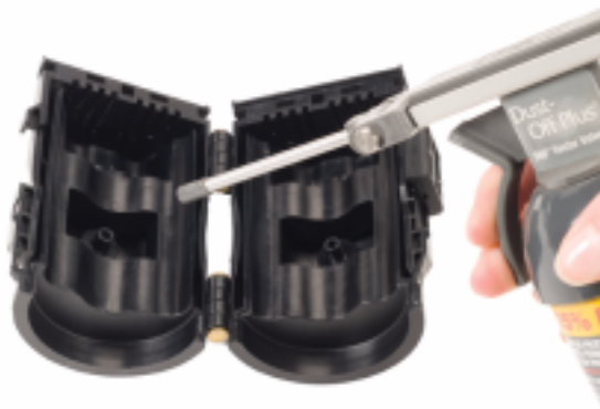
Рис. 20 Чистка защитной крышки
