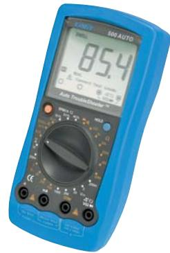
Цифровой мультиметр с автоматическим выбором диапазона измерения и большим дисплеем с подсветкой. Измеряет постоянное/переменное напряжение, постоянный/переменный ток, сопротивление, емкость, частоту, температуру. Обеспечивает проверку диодов, проверку цепей на обрыв с использованием зуммера и сохранение данных, предупреждает о малой емкости аккумулятора. Имеет функцию автоматического выключения.
