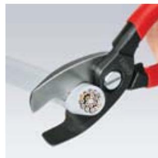
**Вторичный рез:** если требуется большее усилие (при резке проводов), возможна установка кабеля в профиль в режущих кромках у шарнира. Первичный рез — в переднем профиле, вторичный рез — в заднем
