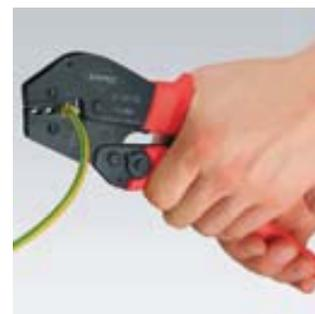
Третий этап: При необходимости увеличенного усилия опрессовки, например, для изолированных контактов 6,00 мм<sup>2</sup>; при наличии удлиненных ручек возможна работа обеими руками
