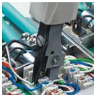
Опрессовка и резание кабеля в одной операции
