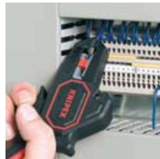
Удаление изоляции в стесненных условиях
