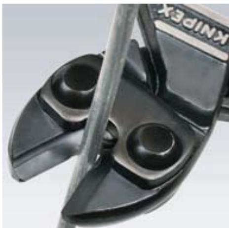
71 31/32/41 200: Благодаря расположению выемки в режущих кромках в непосредственной близости от шарнира, толстая проволока фиксируется в удобном для резки положении (оптимальное соотношение плеч рычага).
