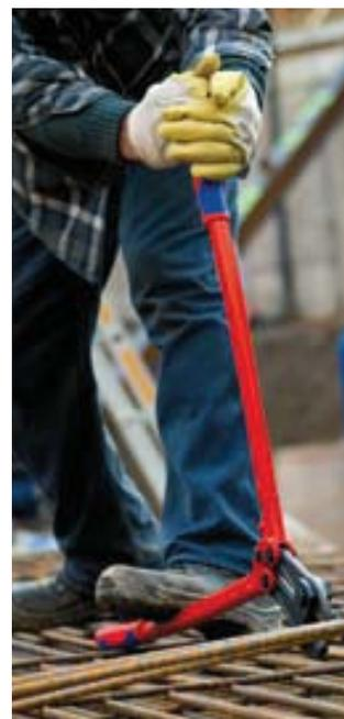
Наваренный ограничитель с гасящей насадкой: удобно амортизирует удары при резке
