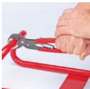
Самофиксируются на трубах и гайках: не соскальзывают с детали
