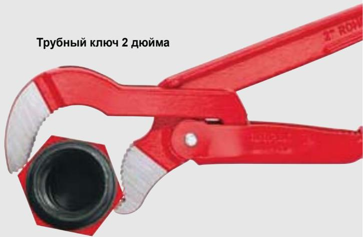
Превышение захватывающей способности; надежный захват более невозможен
