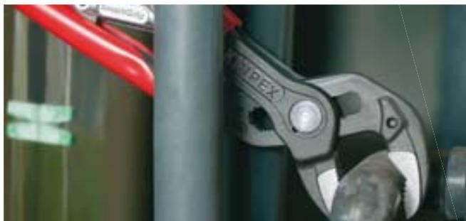
Тонкая, удлиненная форма для хорошего доступа к детали при работе одной рукой
