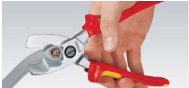
**Вторичный рез:** если требуется большее усилие (при резке проводов), возможна установка кабеля в профиль в режущих кромках у шарнира. Первичный рез – в переднем профиле, вторичный рез – в заднем
