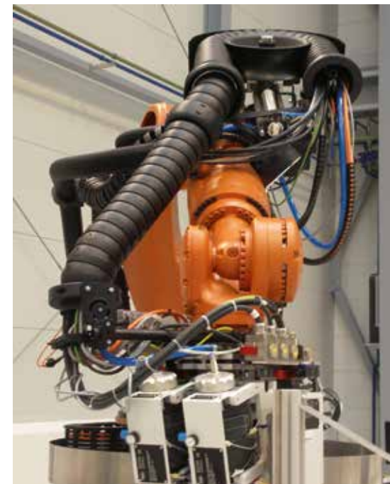
igus® кабели chainflex® в многомерной подвижной энергоцепи triflex® R для 6-осевых роботов
