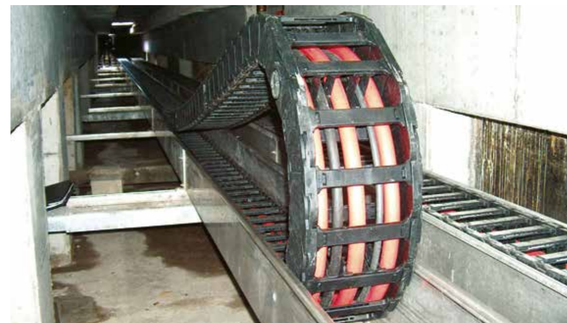
chainflex® CFCRANE для перемещений на 500 м и более. Энергоцепь: igus® rol e-chain®
