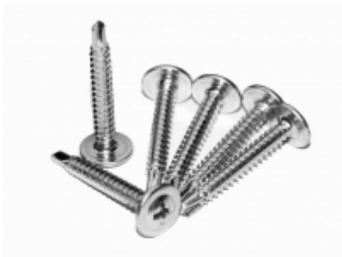
Применяются для монтажных работ, соединения элементов листового металла, тонколистовой стали. Саморезы имеют резьбу с мелким шагом, наконечник со способностью просверливания до 2мм. Саморезы не требуют предварительного сверления отверстий.
