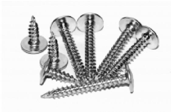
Применяются для монтажных работ, соединения элементов листового металла, тонколистовой стали. Саморезы имеют резьбу с мелким шагом, наконечник со способностью просверливания до 0,9мм. Саморезы не требуют предварительного сверления отверстий.
