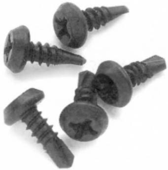
Предназначен для крепления металлических листов профилированного настила и гипсокартонных профилей между собой. Саморезы имеют самосверлящий наконечник со способностью просверливания до 2,0мм и цилиндрическую головку с крестообразным шлицем. Под головкой имеет насечки, препятствующие самопроизвольному откручиванию.
