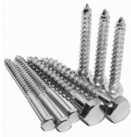
Предназначен для надёжного и прочного крепления больших и длинных предметов к деревянному основанию. Винты изготовлены методом холодной прокатки, с гальваническим оцинкованием. Острый конец и резьба под углом 60 обеспечивает надёжное и прочное соединение.
