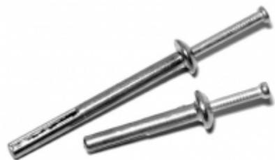
Забивной металлический дюбель предназначен для несъемного крепления профилей и различных тонколистовых материалов к бетону, камню и кирпичу. Возможно сквозное крепление к металлическому профилю соответствующей толщины. Быстрый сквозной монтаж.
