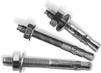
Клиновой анкер используется для крепления тяжелого оборудования к бетону, естественному камню, кирпичу. Сквозная установка. Анкер забивается молотком в предварительно просверленное отверстие в прикрепляемом материале и бетоне, а затем затягивается гайкой.
