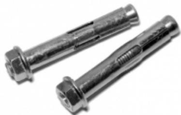
Анкерный болт предназначен для крепления тяжеловесных конструкций. Изготовлен из стальной втулки и стального шестигранной гайки и конусной гайки, с электролитическим цинковым покрытием, желтого цвета, конус стальной с резьбой. Разрезы в распорной части гарантируют надёжную анкеровку и равномерное разложение сил. Поперечная насечка на застёжке анкера облегчает его монтаж. Анкеры характеризуются очень высокой стойкостью к вырыванию и большой распорной силой.
