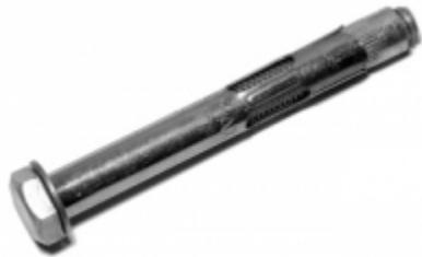
Анкерный болт предназначен для крепления тяжеловесных конструкций. Изготовлен из стальной втулки и стального болта, с электролитическим цинковым покрытием, желтого цвета, конус стальной с резьбой. Разрезы в распорной части гарантируют надёжную анкеровку и равномерное разложение сил. Поперечная насечка на застёжке анкера облегчает его монтаж. Анкеры характеризуются очень высокой стойкостью к вырыванию и большой распорной силой.
