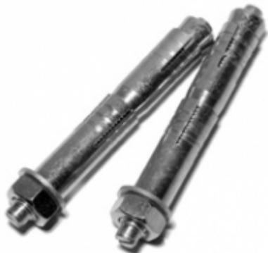
Анкер двухраспорный предназначен для крепления тяжеловесных конструкций. Изготовлен из стальной втулки и стального болта, с электролитическим цинковым покрытием, желтого цвета, конус стальной с резьбой. Разрезы в распорной части гарантируют надёжную анкеровку и равномерное разложение сил. Поперечная насечка на застёжке анкера облегчает его монтаж. Анкеры характеризуются очень высокой стойкостью к вырыванию и большой распорной силой.
