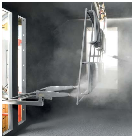
Автоматизированное нанесение порошкового покрытия
