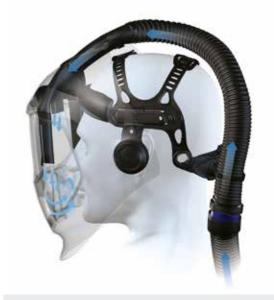
**Поток воздуха:** Поток воздуха из среднего канала практически исключает возможность запотевания фильтра, а два боковых канала равномерно подают воздух к области рта и носа сварщика.
