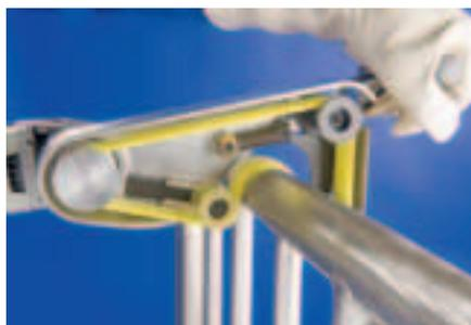
В сочетании с полировальными пастами применяется для предварительного и окончательного полирования конструкций из труб и поручней.
