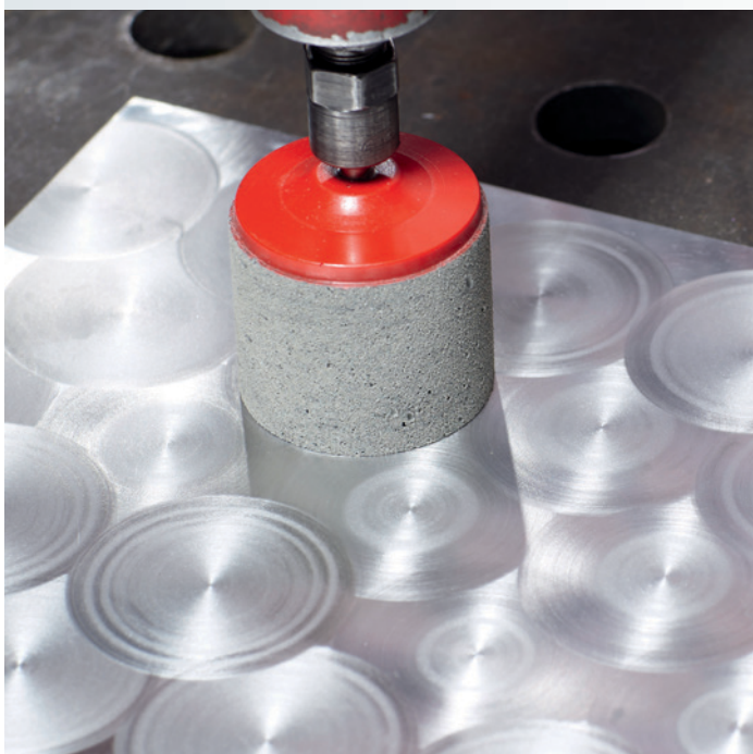
Примеры применения головки для мраморирования Р6
