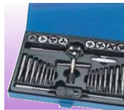
D13291 НАБОР МЕТЧИКОВ И ПЛАШЕК, 28 предметов Изготовлены из углеродистой стали. Применение: чистка и нарезание резьбы в малоуглеродистой стали и алюминии. Поставляется в металлическом футляре с пластиковой вставкой. Картонная упаковка. Комплект: • 8 плашек размерами (мм) 3x0,5, 3,5x0,6, 4x0,7, 5x0,8, 6x1,0, 8x1,25, 10x1,50 и 12x1,75 с внешним диаметром 1" • 8 черновых метчиков, размеры аналогичны размерам вышеперечисленных плашек • 8 чистовых метчиков, размеры аналогичны размерам вышеперечисленных плашек • регулируемый вороток размером 1/2" • торцевой вороток размером 1/4" • клупп • резьбомер
