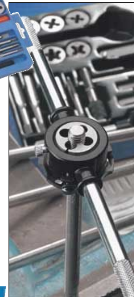
D13292 НАБОР МЕТЧИКОВ И ПЛАШЕК, 33 предмета Изготовлены из углеродистой стали. Применение: чистка и нарезание резьбы в малоуглеродистой стали и алюминии. Поставляется в металлическом футляре с пластиковой вставкой. Картонная упаковка. Комплект: • 7 плашек размерами (мм) 3x0,5, 4x0,7, 5x0,8, 6x1,0, 8x1,25, 10x1,50 и 12x1,75 с внешним диаметром 1" • 5 плашек для резьбы с мелким шагом (UNF) размерами 1/4, 5/16, 3/8, 7/16 и 1/2 с внешним диаметром 1" • 2 плашки для мелкой резьбы (BSP) размерами 1/8 и 1/4 с внешним диаметром 1" • 14 метчиков для (мм), (UNF) и (BSP) резьбы, размеры аналогичны размерам вышеперечисленных плашек • регулируемый вороток размером 1/2" • торцевой вороток размером 1/4" • клупп • резьбомер • отвертка
