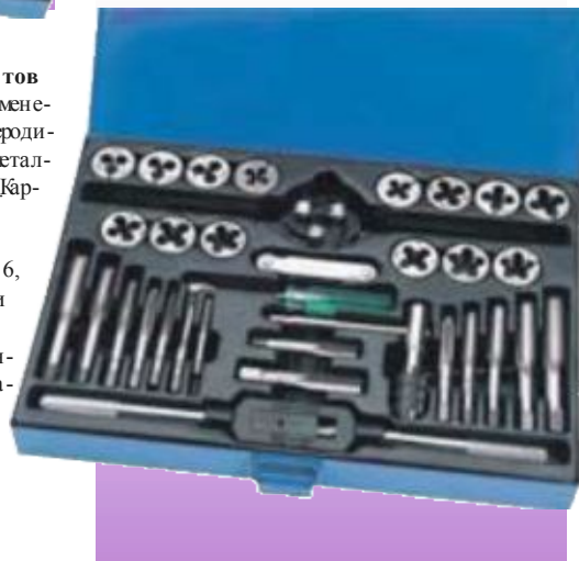
D13292 НАБОР МЕТЧИКОВ И ПЛАШЕК, 33 предмета Изготовлены из углеродистой стали. Применение: чистка и нарезание резьбы в малоуглеродистой стали и алюминии. Поставляется в металлическом футляре с пластиковой вставкой. Картонная упаковка. Комплект: • 7 плашек размерами (мм) 3x0,5, 4x0,7, 5x0,8, 6x1,0, 8x1,25, 10x1,50 и 12x1,75 с внешним диаметром 1" • 5 плашек для резьбы с мелким шагом (UNF) размерами 1/4, 5/16, 3/8, 7/16 и 1/2 с внешним диаметром 1" • 2 плашки для мелкой резьбы (BSP) размерами 1/8 и 1/4 с внешним диаметром 1" • 14 метчиков для (мм), (UNF) и (BSP) резьбы, размеры аналогичны размерам вышеперечисленных плашек • регулируемый вороток размером 1/2" • торцевой вороток размером 1/4" • клупп • резьбомер • отвертка
