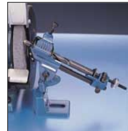
D10751 УСТРОЙСТВО ДЛЯ ЗАТОЧКИ СВЕРЛА Предназначено для применения совместно со стандартными настольными заточными станками. Позволяет быстро и точно заточивать спиральные сверла диаметром от 3 до 19 мм. Возможность фиксации сверла под углами 41°, 49°, 59°, 68° и 88°. Картонная упаковка.
