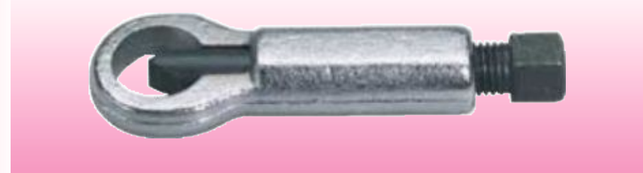
D10913 ГАЙКОРЕЗ 9–12 мм Предназначен для безопасного удаления прижавшихся поврежденных гаек. Корпус изготовлен из среднеуглеродистой стали методомковки с последующим хромированием. Резец произведен из хромомолибденовой стали. Длина 80 мм. Прозрачная упаковка.
