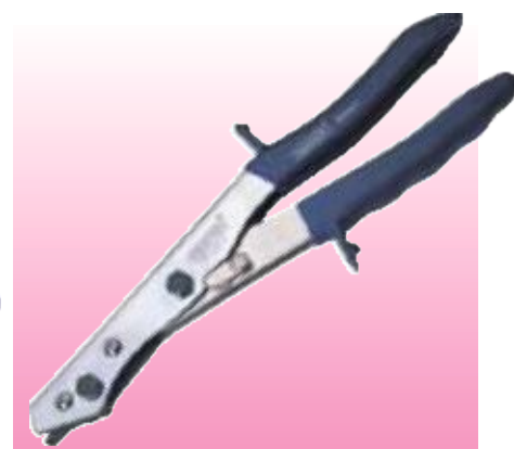
D35748 ВЫРУБНЫЕ НОЖНИЦЫ Профессиональное качество. Предназначены для резки различных материалов без их скручивания и порчи. Способны разрезать листовый металл толщиной до 1,2 мм и полимерные материалы толщиной до 2 мм. Сменные лезвия имеют остро заточенные кромки. Подпружиненные ручки изолированы и снабжены упорами для безопасной работы. Длина 250 мм. Прозрачная упаковка.
