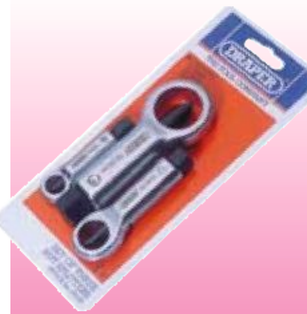
D55108 НАБОР ИЗ 3 ГАЙКОРЕЗОВ 9–12 мм, 12–16 мм и 16–22 мм. Предназначен для безопасного удаления прижавшихся поврежденных гаек. Корпус изготовлен из среднеуглеродистой стали методомковки с последующим хромированием. Резец произведен из хромомолибденовой стали. Прозрачная упаковка.
