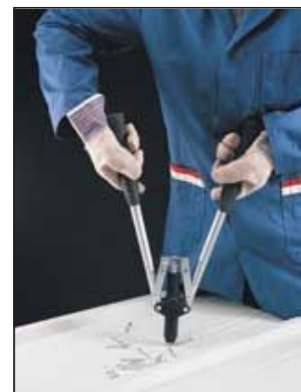
ЗАКЛЁПОЧНИК МНОГОРЫЧАЖНЫЙ Профессиональное качество. Специально разработан для часто повторяющихся операций при интенсивном использовании. Имеет сверхпрочный рычажный механизм ножничного типа и патрон, изготовленные из углеродистой стали, литую алюминиевую ручку, покрытую лаком, и рабочие губки, изготовленные из закалённой хромомолибденовой стали. В комплект входят 4 головки, предназначенные для односторонних заклёпок, изготовленных из алюминиевого сплава, нержавеющей и обычной стали, размерами 2,4, 3,2, 4,0 и 4,8 мм. Упаковка – прозрачная.
