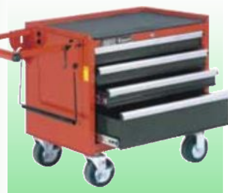
ИНСТРУМЕНТАЛЬНЫЙ ШКАФ НА КОЛЁСАХ С 4 ВЫДВИЖНЫМИ СЕКЦИЯМИ Профессиональное качество. Инструментальный шкаф изготовлен из листовой стали и окрашен порошковым методом. На боковой стенке шкафа имеется ручка и диспенсер для бумажных полотенец. Оснащён четырьмя поворотными колёсами (два из которых с тормозным механизмом) большого диаметра с широкими шинами. Секции снабжены противоскользящими ковриками и мягко выдвигаются на роликовых опорных планках. Оснащён замком (два ключа входят в комплект). Может использоваться как отдельно, так и в комплекте с инструментальным ящиком (артикул D78219). Упаковка картонная. Конфигурация: • 3 выдвижных секции размерами 578x380x56 мм • 1 выдвижная секция размерами 578x380x123 мм Артикул Размеры, длина x ширина x высота, мм D78220 670 x 460 x 630
