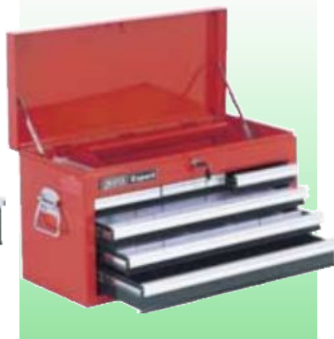
ИНСТРУМЕНТАЛЬНЫЙ ЯЩИК С 6 ВЫДВИЖНЫМИ СЕКЦИЯМИ Профессиональное качество. Состоит из 6 выдвижных секций и съёмного инструментального лотка, изготовленных из листовой стали и окрашенных порошковым методом. По бокам ящика имеются прочные ручки. В комплект входят пластиковые перегородки для хранения мелких деталей. Секции снабжены противоскользящими ковриками и мягко выдвигаются на роликовых опорных планках. Оснащён замком (два ключа входят в комплект). Упаковка картонная. Конфигурация: • 2 выдвижных секции размерами 572x410x46 мм каждая • Одна выдвижная секция размерами 572x270x65 мм • 3 выдвижных секции размерами 172x275x41 мм • Переносной лоток Артикул Размеры, длина x ширина x высота, мм D78216 660 x 305 x 380
