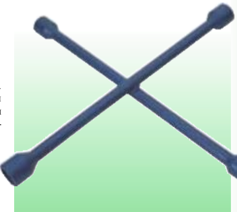
D36005 УСИЛЕННЫЙ КРЕСТОВОЙ БАЛЛОННЫЙ КЛЮЧ Размерность 17x19x21x22 мм. Длина 380 мм. Окрашен для предотвращения коррозии. Поставляется без упаковки.
