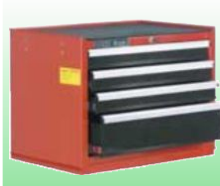
ИНСТРУМЕНТАЛЬНЫЙ ЯЩИК С 4 ВЫДВИЖНЫМИ СЕКЦИЯМИ Профессиональное качество. Секции инструментального ящика изготовлены из листовой стали и окрашены порошковым методом. Секции снабжены противоскользящими ковриками и мягко выдвигаются на роликовых опорных планках. Оснащён замком (два ключа входят в комплект). Предназначен для установки в качестве верхней секции инструментального шкафа (артикул D78220). Упаковка картонная. Конфигурация: • 3 выдвижных секции размерами 578x380x56 мм каждая • Одна выдвижная секция размерами 578x380x123 мм Артикул Размеры, длина x ширина x высота, мм D78219 670 x 460 x 500
