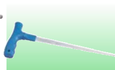
D65549 ИНСТРУМЕНТ ДЛЯ ПОДАЧИ ПРОВОЛОКИ Профессиональное качество. Предназначено для протаскивания (подачи) проволоки при демонтаже вклеенного лобового стекла. Длина устройства – прибл. 265 мм. Может поставляться вместе с тросом. Упаковка – прозрачная.
