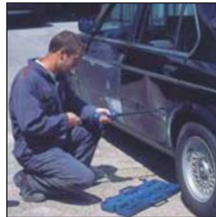
D52321 ОБРАТНЫЙ МОЛОТ ОК В НАБОРЕ, 9 предметов Упакован в переносной формованный футляр. Комплект: • Скользящий молоток весом 2,3 кг со стержнем длиной 470 мм • Большой плоский крюк • Малый плоский крюк • Большой стержневой крюк • Малый стержневой крюк • Винтодержатель • Самонарезающийся винт • Конический винт • Адаптер
