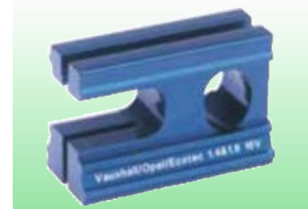
D69928 БЛОКИРАТОР РАСПРЕДЕЛИТЕЛЬНОГО ВАЛА, ДЛЯ ДВИГАТЕЛЕЙ GM (VAUXHALL / OPEL) Профессиональное качество. Предназначен для блокировки распределительного вала (двигатели с 1 распредвалом) 16-клапанного бензинового двигателя на автомобилях марок GM (Vauxhall / Opel) Ecotec 1.4 и 1.6л. Изготовлен из анодированного алюминия. Упаковка – прозрачная.
