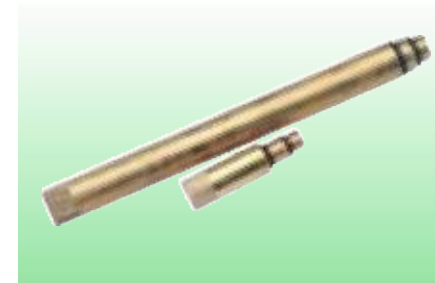
D51012 АДАПТЕР-УДЛИНИТЕЛЬ ДЛЯ КОМПРЕССОМЕТРА Профессиональное качество. Применяется с приборами для проверки утечки из цилиндров бензинового двигателя (включая модель D36288) и аналогичными инструментами для двигателей с глубоко утопленными свечами зажигания (Ford Mondeo, Renault). Длина 200 мм. Резьба 14x18 мм с адаптером 10x12 мм. Прозрачная упаковка.
