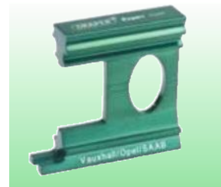
D69934 БЛОКИРАТОР РАСПРЕДЕЛИТЕЛЬНОГО ВАЛА, ДЛЯ ДИЗЕЛЬНЫХ И БЕНЗИНОВЫХ ДВИГАТЕЛЕЙ GM (VAUXHALL / OPEL) И SAAB Профессиональное качество. Предназначен для блокировки распределительного вала (двигатели с 1 распредвалом) на автомобилях марок GM (Vauxhall / Opel) и Isuzu (см. перечень ниже). Изготовлен из анодированного алюминия. Бензиновые двигатели: GM (Vauxhall / Opel) OHC 1.2, 1.4, 1.6, 1.8 и 2.0л; Saab 900 2.5л V6 и Saab 9000 3.0л V6. Дизельные двигатели: GM (Vauxhall / Opel) OHC 1.6 и 1.7л; Isuzu 1.5 и 1.7л.
