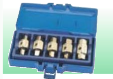
D56627 НАБОР КЛЮЧЕЙ ДЛЯ СЛИВНЫХ ПРОБОК, 5 ПРЕДМЕТОВ Ключи изготовлены из закалённой хромованадиевой стали с бронзовым покрытием. Ключи двусторонние. В пластиковом футляре. Комплект: 5/8" – 9 мм шестигранник; 3/8" – 11 мм квадрат; 10 – 12 мм шестигранник; 8 – 13 мм квадрат и 14 – 17 мм шестигранник.
