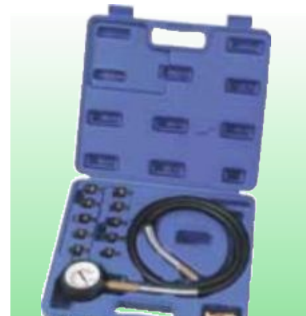
D68992 НАБОР ДЛЯ ПРОВЕРКИ ДАВЛЕНИЯ МАСЛА Профессиональное качество. Применяется для точного измерения давления масляного насоса, проверки включения и работы сигнальных индикаторов. Оснащен большим удобным для чтения манометром, позволяющим проводить измерения в диапазоне 0–10 бар, и 1300-миллиметровым гибким шлангом с быстроразъемным соединением, к которому возможно подключение 10 типов переходников, подходящих для большинства типов современных автомобилей. Поставляется в пластиковом футляре.
