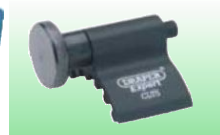
D71204 БЛОКИРАТОР РАСПРЕДЕЛИТЕЛЬНОГО ВАЛА, ДЛЯ ДИЗЕЛЬНЫХ ДВИГАТЕЛЕЙ VOLKSWAGEN Профессиональное качество. Предназначен для блокировки распределительного вала дизельных двигателей моделей Lupo 3L 1.2TDI, Lupo 1.4TDI, Polo 1.4TDI, Golf 1.9TDI, Bora 1.9TDI и Passat 1.9TDI. Упаковка – прозрачная.
