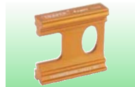
D69929 БЛОКИРАТОР РАСПРЕДЕЛИТЕЛЬНОГО ВАЛА, ДЛЯ ДВИГАТЕЛЕЙ GM (VAUXHALL / OPEL) Профессиональное качество. Предназначен для блокировки распределительного вала (двигатели с 1 распредвалом) 16-клапанного бензинового двигателя на автомобилях марок GM (Vauxhall / Opel) Ecotec 1.8 и 2.0л. Изготовлен из анодированного алюминия. Упаковка – прозрачная.
