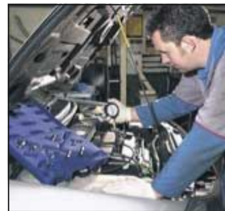
D68992 НАБОР ДЛЯ ПРОВЕРКИ ДАВЛЕНИЯ МАСЛА Профессиональное качество. Применяется для точного измерения давления масляного насоса, проверки включения и работы сигнальных индикаторов. Оснащен большим удобным для чтения манометром, позволяющим проводить измерения в диапазоне 0–10 бар, и 1300-миллиметровым гибким шлангом с быстроразъемным соединением, к которому возможно подключение 10 типов переходников, подходящих для большинства типов современных автомобилей. Поставляется в пластиковом футляре.
