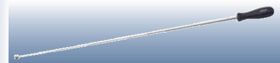
D33080 ТЕЛЕСКОПИЧЕСКИЙ ЗАХВАТ С МАГНИТНЫМ НАКОНЕЧНИКОМ Применяется для захвата гаек, болтов, винтов и других некрупных металлических предметов, попавших в труднодоступные места. Изменяемая длина 90–420 мм. Прозрачная упаковка.
