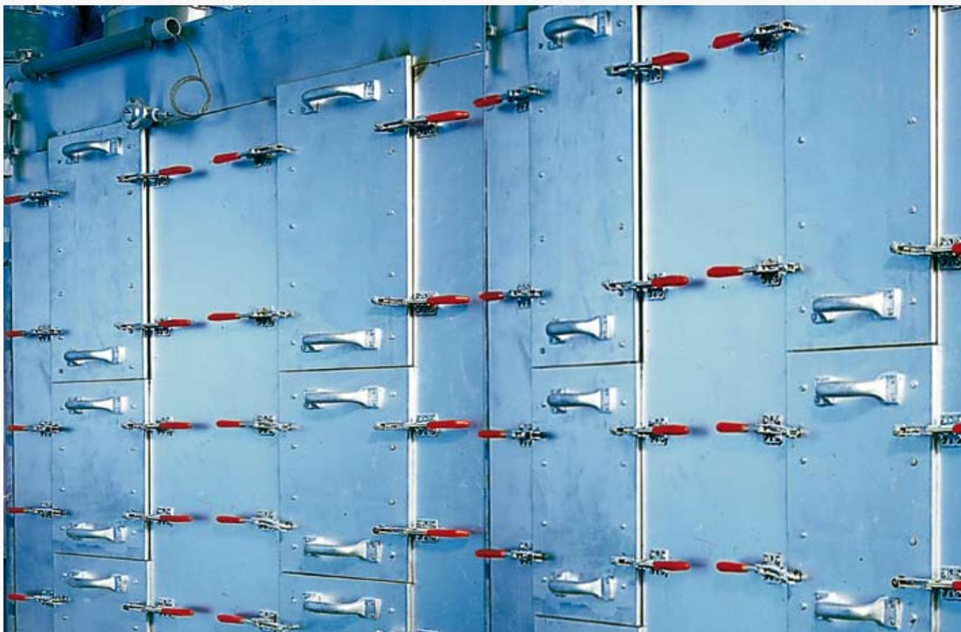
Применение ручных зажимных устройств, например в производстве промышленного оборудования: Ручные зажимные устройства AMF отличаются надежностью и длительным сроком службы. Рисунок: Горизонтальное зажимное устройство № 6830.
