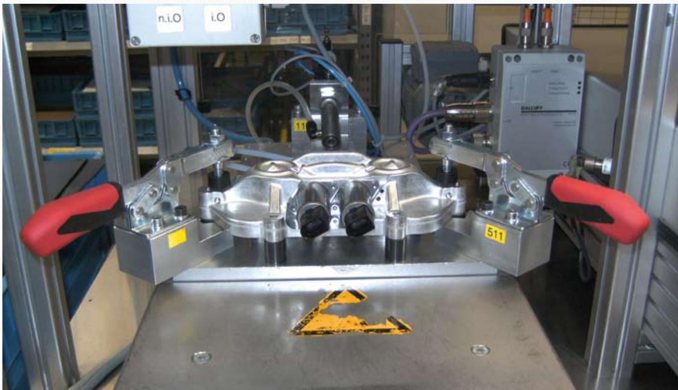
Горизонтальное зажимное устройство № 6830 для применения на приспособлении для проверки герметичности. Закреплен компонент для регулировки кулачкового вала.
