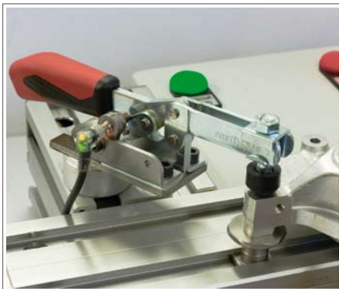
Горизонтальное зажимное устройство с запрашивающим датчиком для решений по автоматизации
